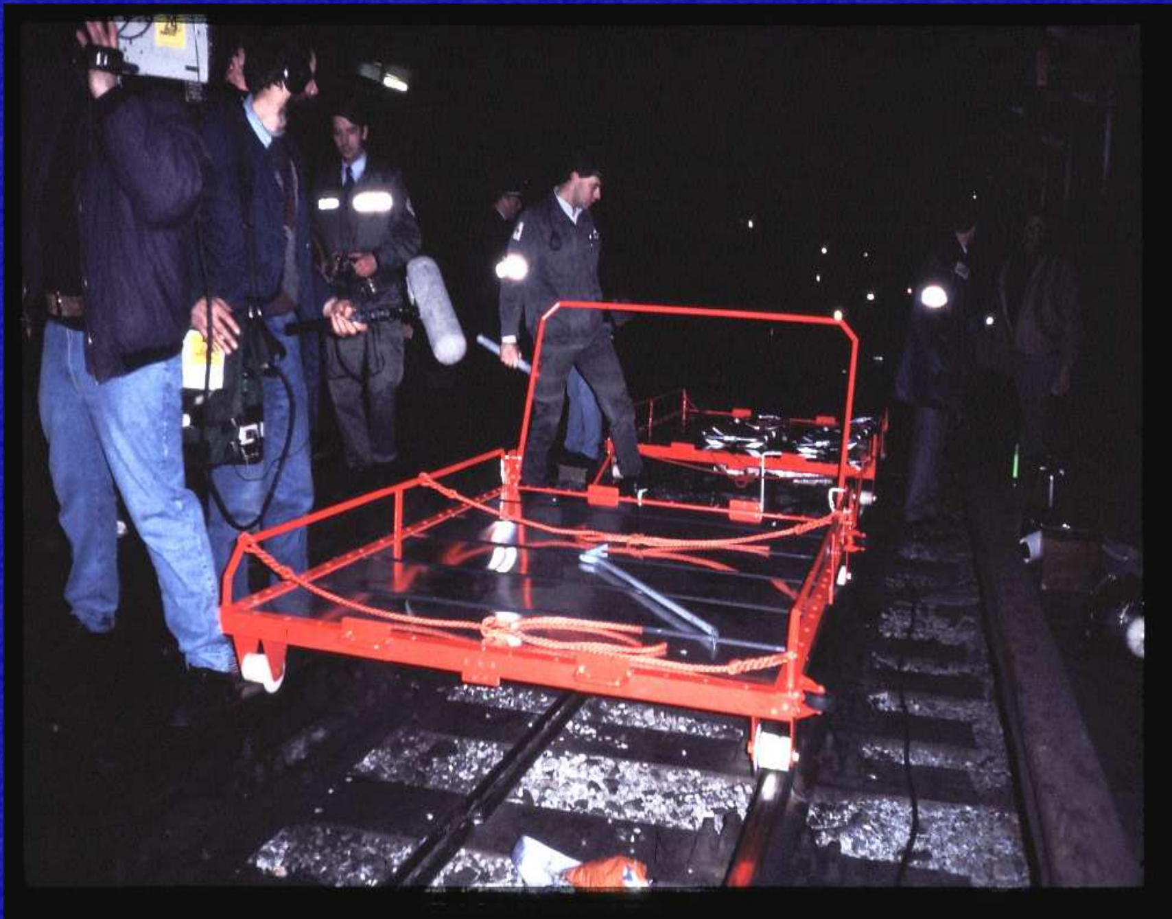
Lorry = wagonnet plat utilisé pour l'entretien des voies ferrées.
